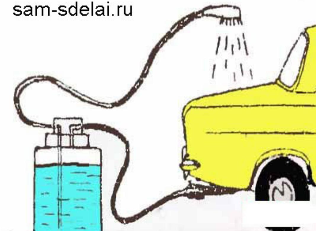
Конструкция самодельной мини мойки, вода нагнетается на шланг с щеткой из емкости с помощью выхлопных газов.
