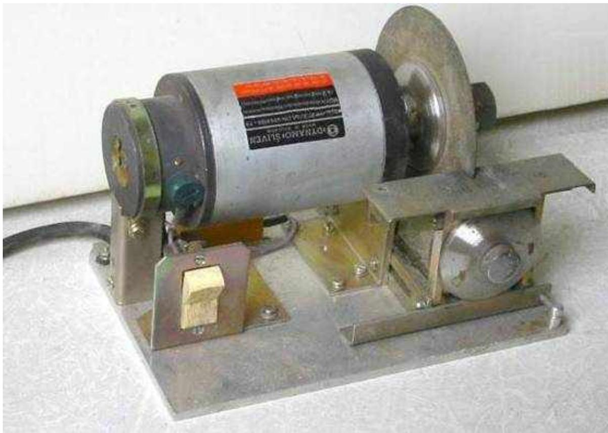
Отрезной станок 1 сделан под неармированные абразивные диски толщиной 0,5-2 мм.
