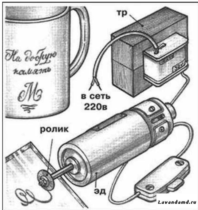
Для самостоятельного изготовления полезного устройства Вам понадобится электродвигатель (до 30 В), фреза, изготовленная из резца от стеклореза и переходник для крепления фрезы к оси двигателя.
