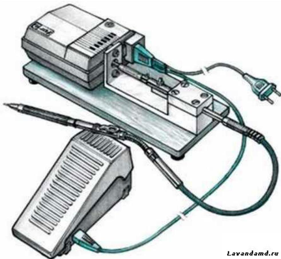
**Рис. 1.** Общий вид станка (бор машины на гибком валу)
