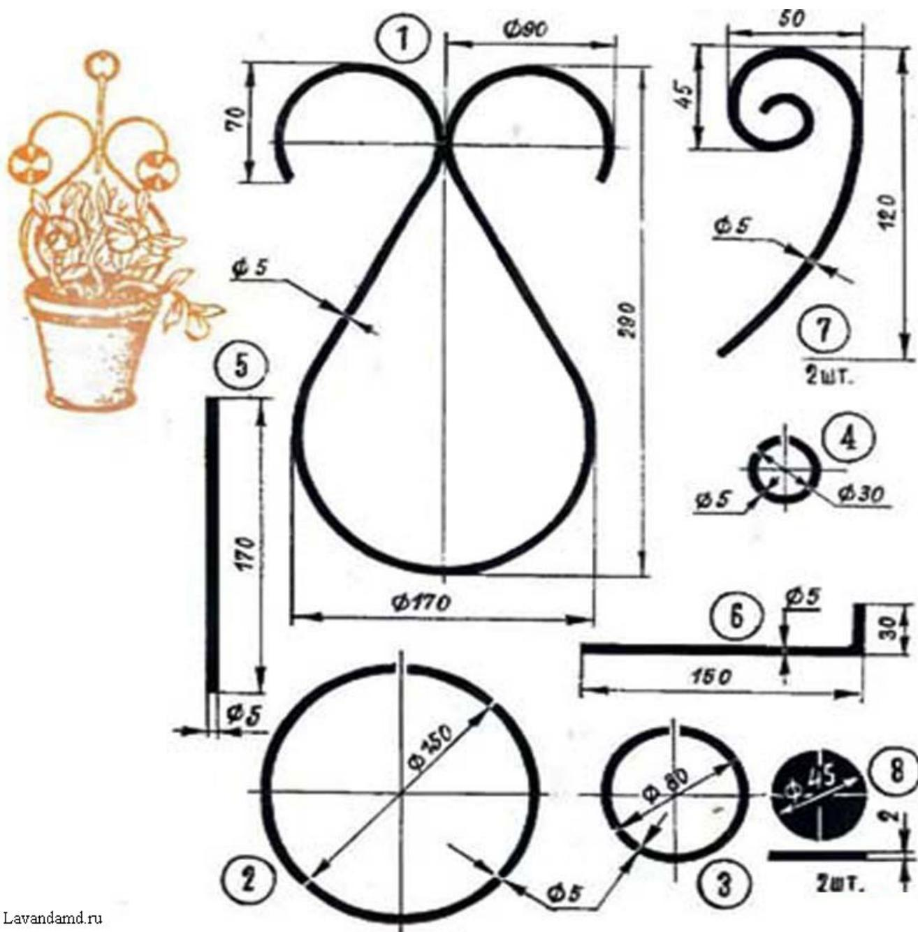
***Рис.2 Схема с размерами деталей самодельной подставки.***
