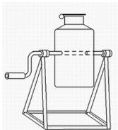
Самодельная ручная бетономешалка может быть сделана за 2 часа из молочной фляги и любого металлолома
