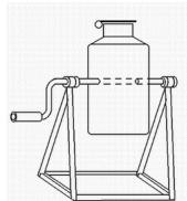
Самодельная ручная бетономешалка может быть сделана за 2 часа из молочной фляги и любого металломолома
