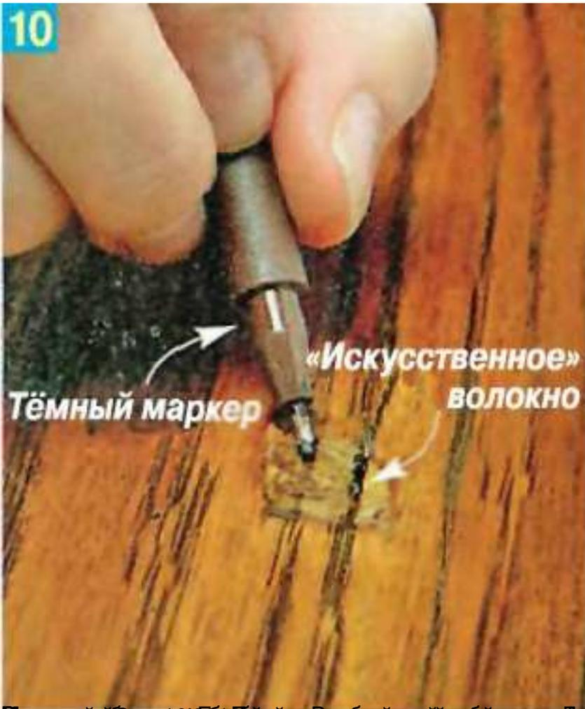
Рис. 10. Нанесение искусственного волокна на поверхность древесины с помощью темного маркера.
