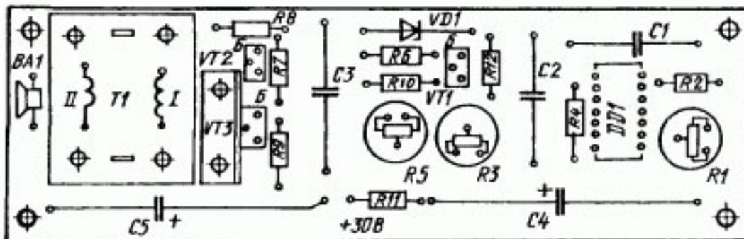
Разработанный мною пульт охранной сигнализации (ПОС) способен контролировать сразу девятнадцать различных объектов и при их вскрытии подавать световые и звуковые сигналы. Удаленность любого из объектов от пульта может достигать 10 километров.
