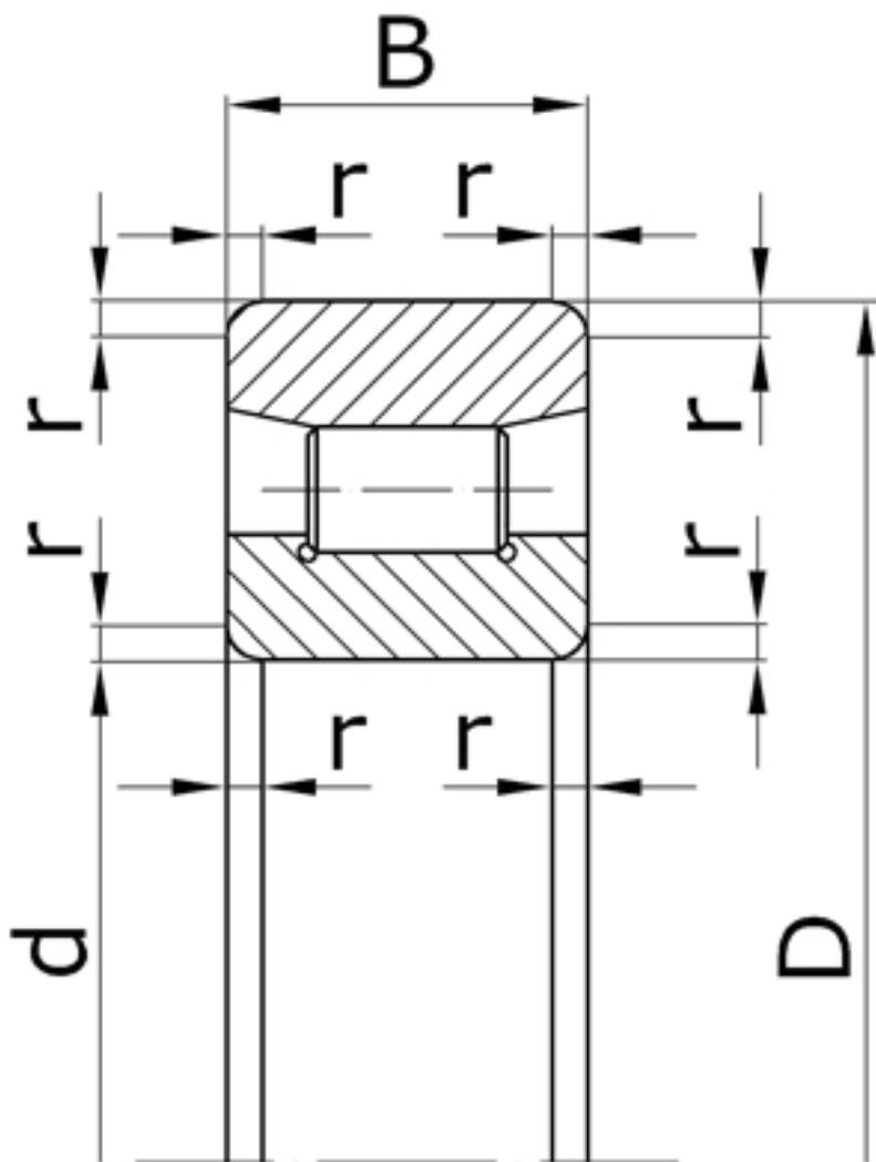
Характеристики подшипника 2138 Параллельно-цилиндровый
