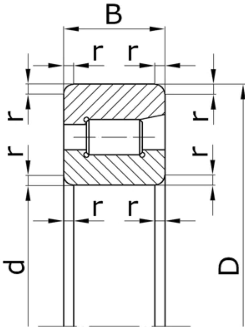
Характеристики подшипника 12317 Параллельные ролики
