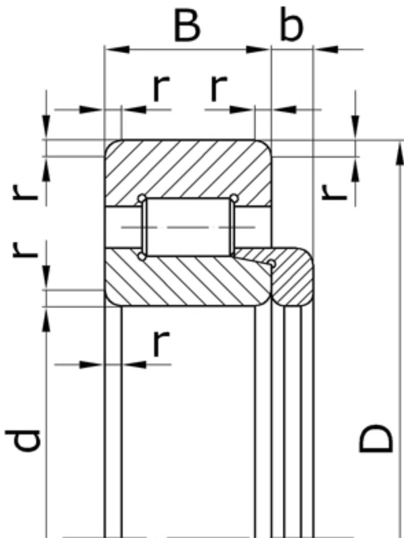
Характеристики подшипника 62312 Параллельно-цилиндрические
