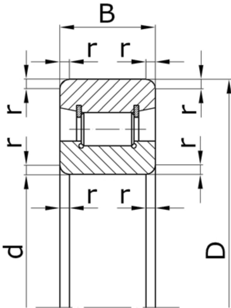
Характеристики подшипника 102204 Параллельные ролики
