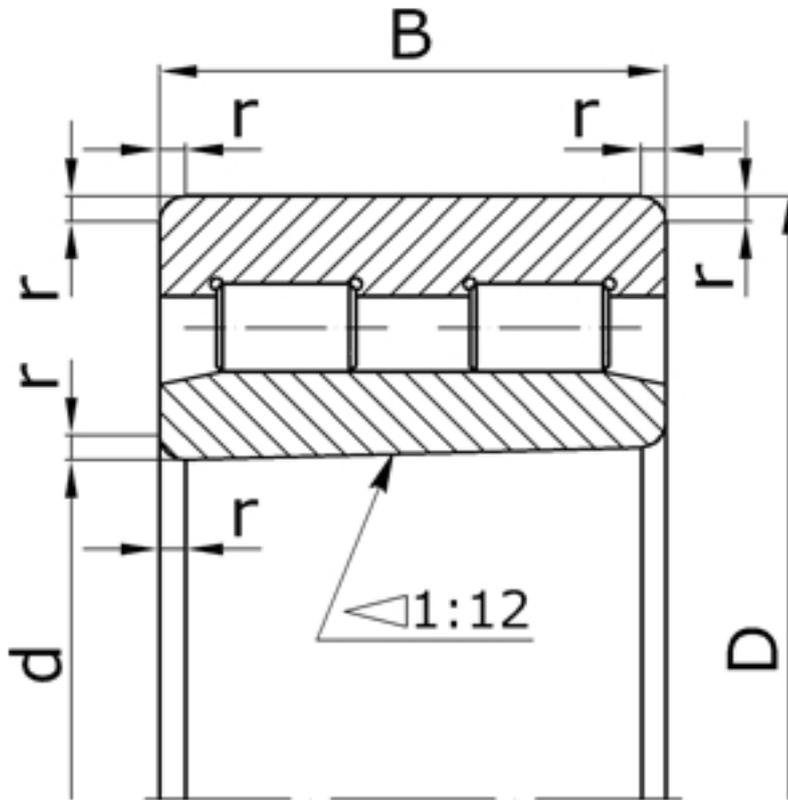
Характеристики подшипника 4162968 Параллельные ролики
