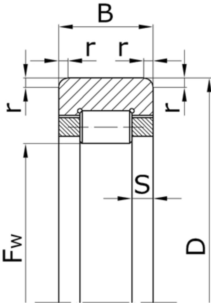
Характеристики подшипника 292110 Параллельно-цилиндровый
