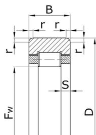
Характеристики подшипника 292212 Параллельные ролики
