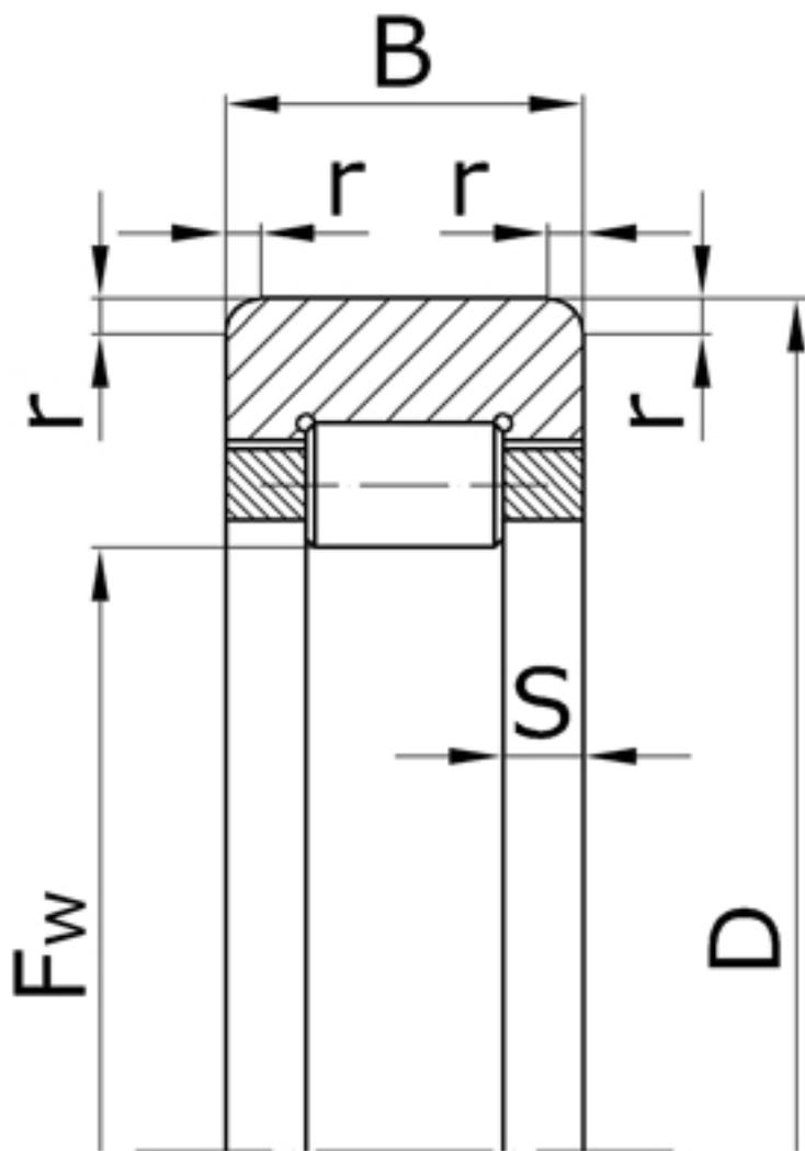
Характеристики подшипника 292406Н Параллельно-цилиндровый подшипник
