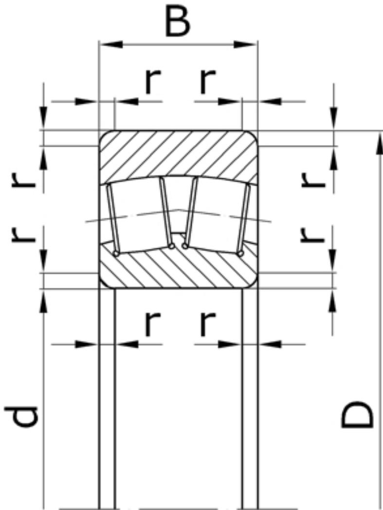
Характеристики подшипника 3516 Параллельные ролики
