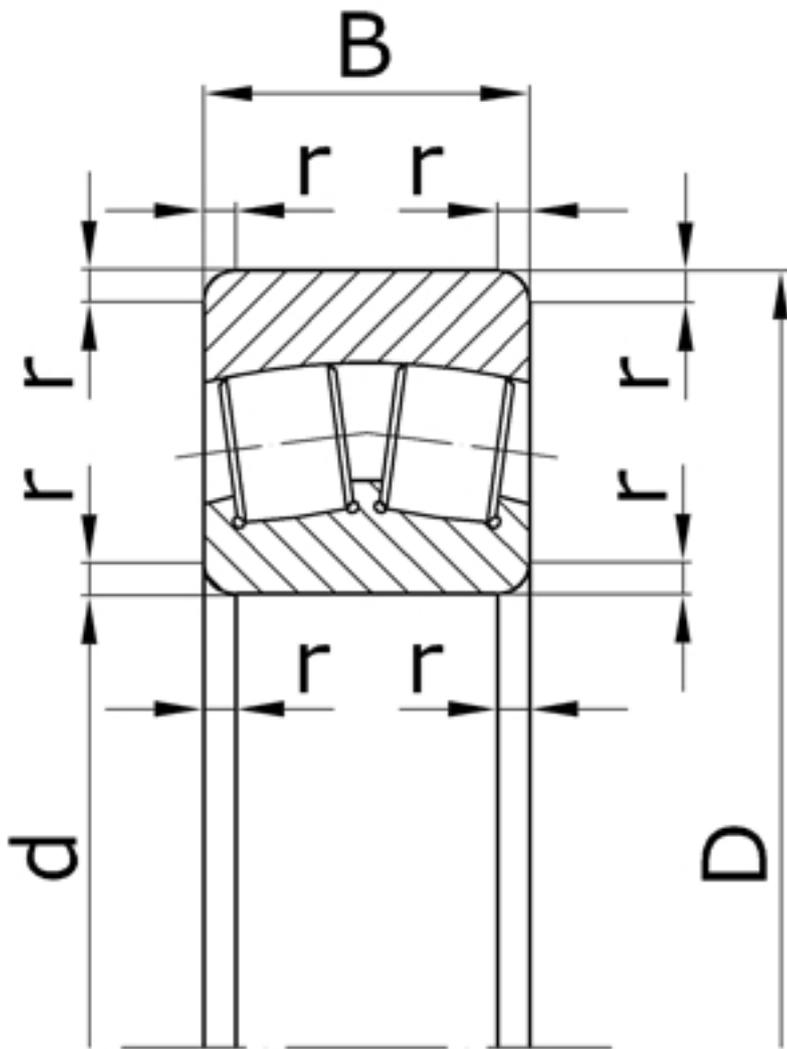
Характеристики подшипника 3608 Параллельные ролики
