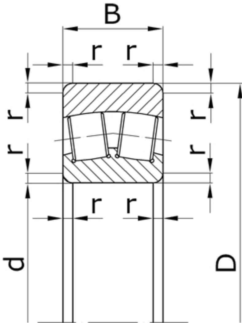
Характеристики подшипника 3003296 Параллельные ролики
