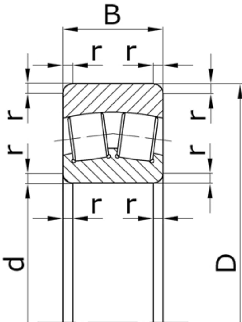
Характеристики подшипника 4003734 Параллельные ролики
