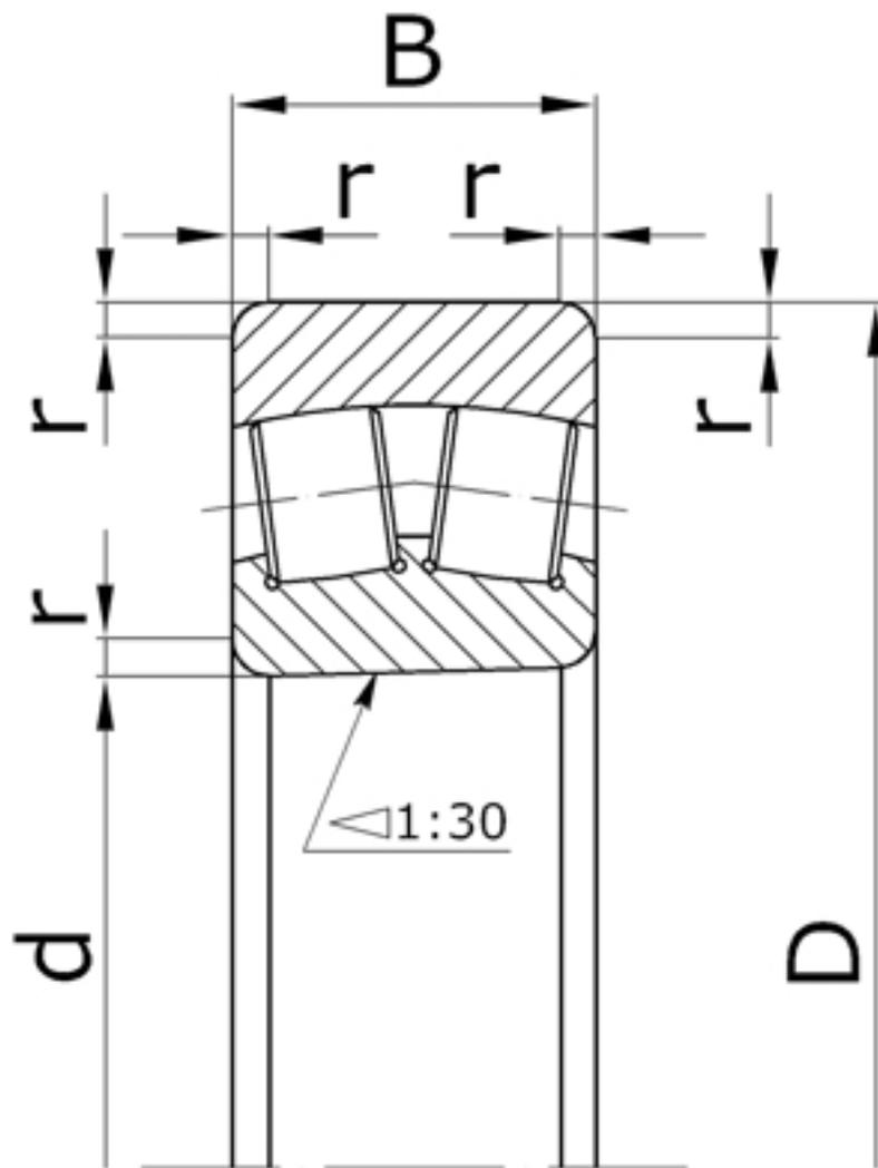
Характеристики подшипника 4113138 Параллельные ролики
