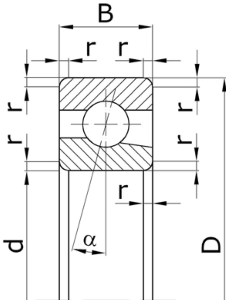
Характеристики подшипника 36120K7 Параллельные нагрузки
