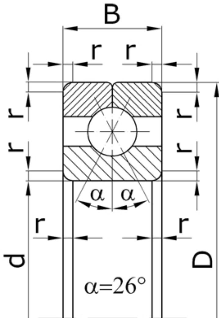
Характеристики подшипника 116317 Параллельные ролики
