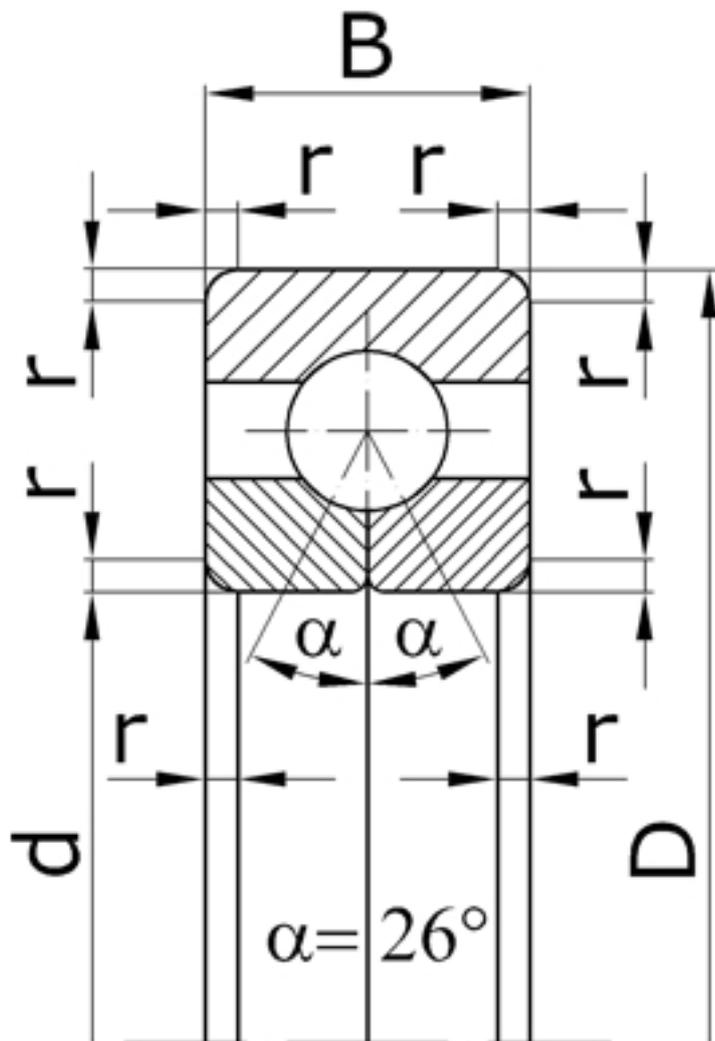
Характеристики подшипника 126104 Параллельные оси
