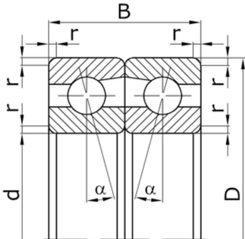
Характеристики подшипника 336105 Параллельные оси
