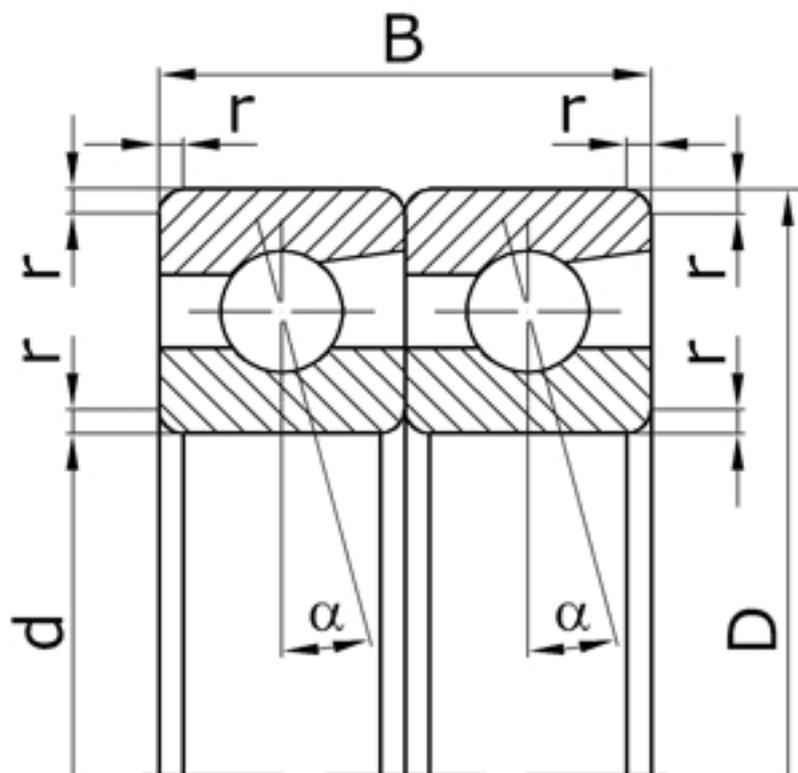
Характеристики подшипника 436215 Параллельные ролики
