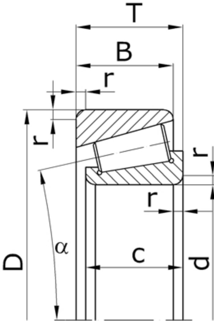
Характеристики подшипника 7532 Параллельные ролики
