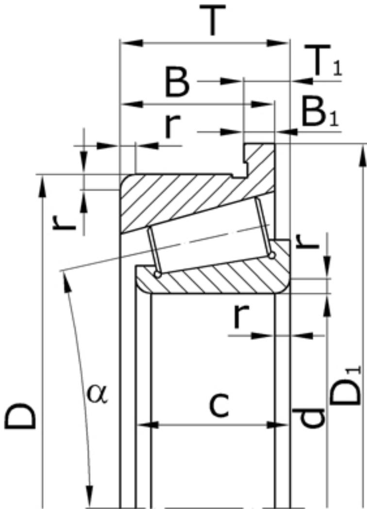
Характеристики подшипника 7505А Параллельные ролики
